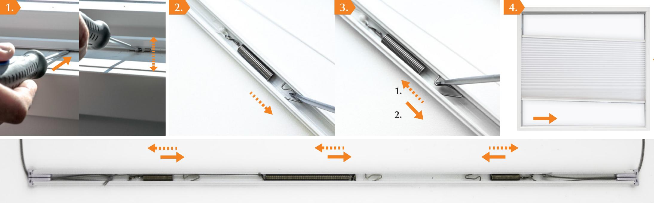
**Tightening the mechanism / Mekanismen kiristys / Spänning av mekanismen / Stramme mekanismen / Stramning af mekanismen / Spannmechanismus / Натяжение механизма / Ajustar el mecanismo / Serrage du mécanisme**
